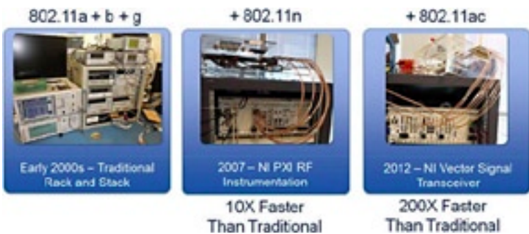
图4. Qualcomm Atheros通过仪器的射频前端元件直接同步处理数字控制时序, 测试速度比以前的PXI解决方案快了20倍以上, 甚至超越原本的传统仪器解决方案200倍之多
